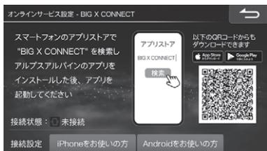
インストール後、スマートフォンと本機を接続します。iPhoneとAndroidスマートフォンでは接続方法が異なります。AndroidスマートフォンはWi-Fiで本機と接続します。iPhoneをご使用の場合、本機添付のUSBケーブルとiPhoneに添付の接続ケーブルを使用して接続するかBluetoothで接続します。
