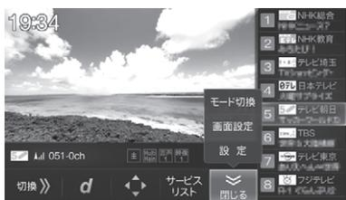
**モード切換** :主/副音声の切りかえ・字幕の切りかえ・多言語放送の音声切りかえを行うことができます。選択した内容はインジケータに表示されます。視聴している番組が音声多重放送かどうかなどについては、番組の詳細情報画面で確認できます。
