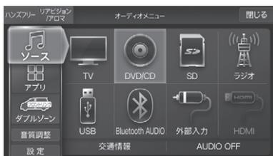
ディスクが入っていない場合は、[開/閉]または[▲]スイッチを押してディスプレイを開き、レーベル面を上にしてDVD/CD挿入口にディスクを挿入すると、自動的にディスプレイが閉まり再生が始まります。XF11NXシリーズのみ、ディスプレイ上部を持って手前に倒してディスクを挿入します。
