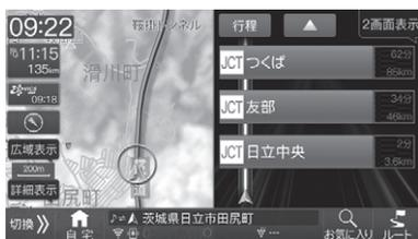
ルート案内中に高速道路上のジャンクションやインターチェンジの混雑状況を表示できます。行程ガイド表示中に **高速渋滞** にタッチするとジャンクション混雑状況を表示する高速渋滞モードに切りかわり、それぞれの距離および所要時間を示す数字の色が混雑状況に応じて変化します。
