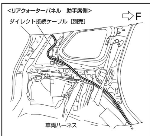
3. ダイレクト接続ケーブル [別売] をリアクォーターパネルの車両ハーネスに沿って車両前方へ配線します。
