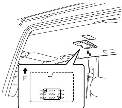
**注意** ※ 取り付けブラケットを固定するとき、ルームランプを固定してあるパネルと天井内装パネルに隙間があると固定用ネジの締め込みが出来ない場合があります。
