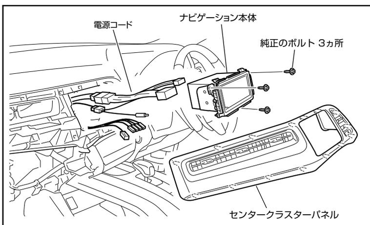
6. 接続図を参照して配線を接続します。
