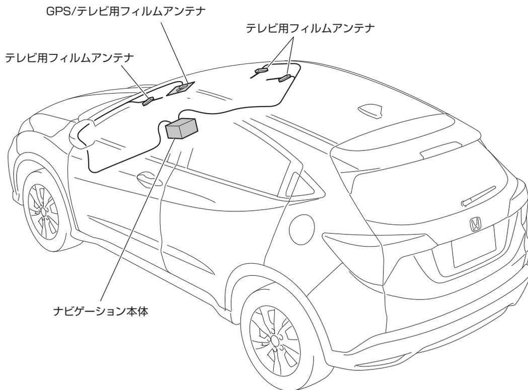
※図は製品を取り付けた取付概要図になります。
