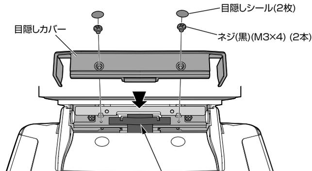
接続端子部分を傷つけないよう注意し、目隠しカバーで押さえつけながら固定してください。
