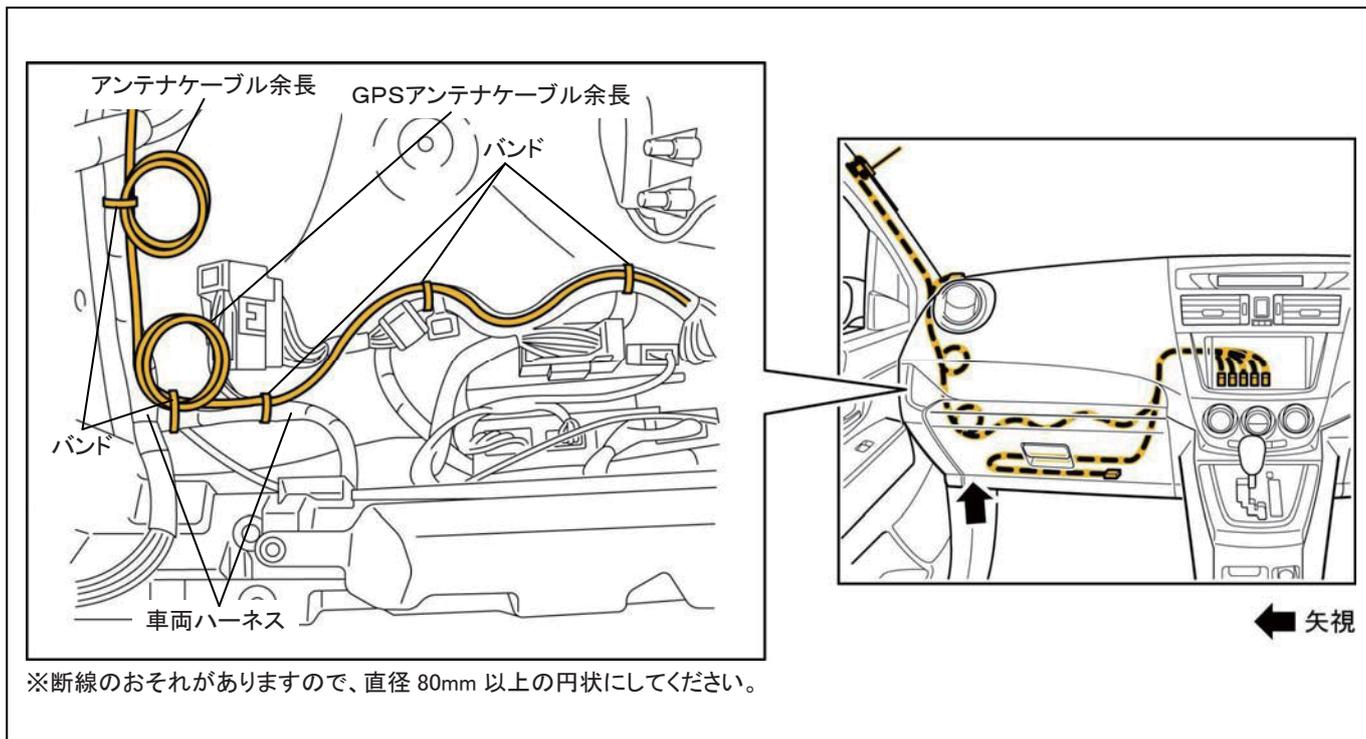
4. アンテナケーブルおよびGPSアンテナケーブルをバンドで車両ハーネスに固定します。
