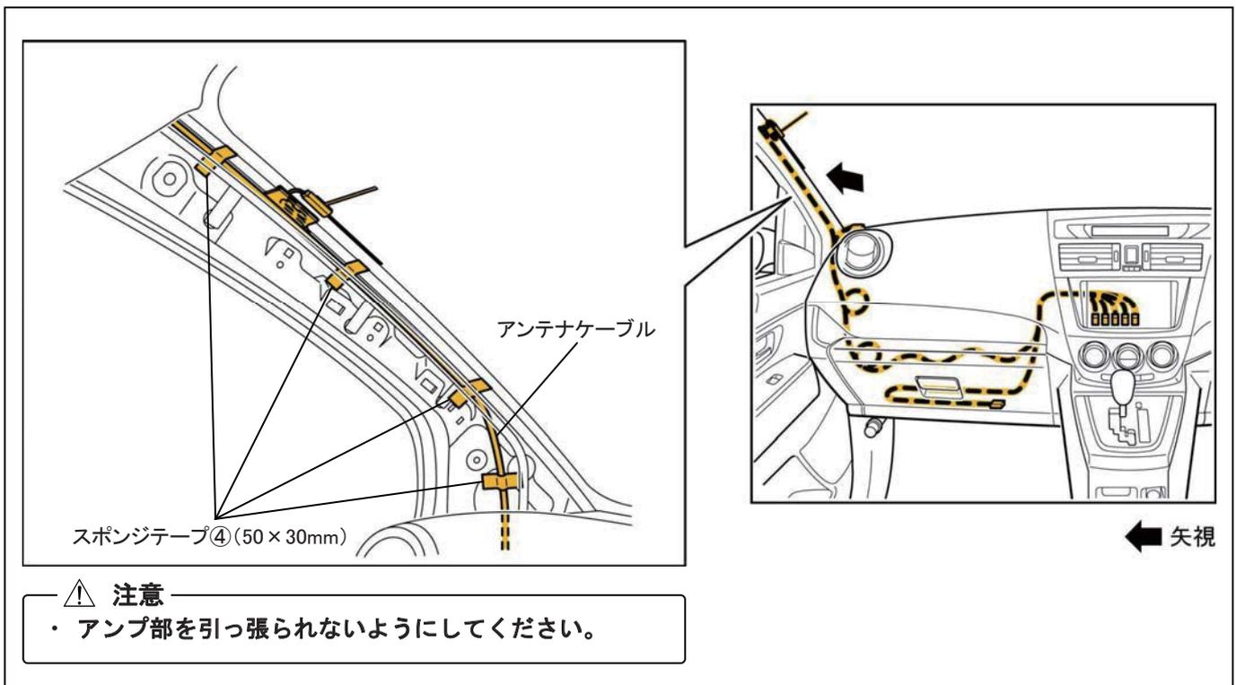
3. 図示の位置でアンテナケーブルおよびGPSアンテナケーブルの余長を束ね、バンドで車両ハーネスに固定します。
