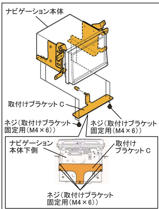
3. 取付けブラケット C を取付けブラケット (A, B) にネジ (取付けブラケット固定用 (M4×6)) で固定します。
