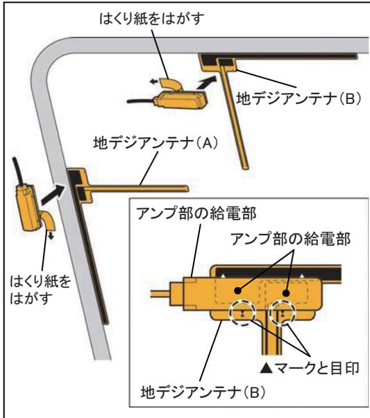
1. アンテナケーブルのアンプをエレメントに貼付けます。
