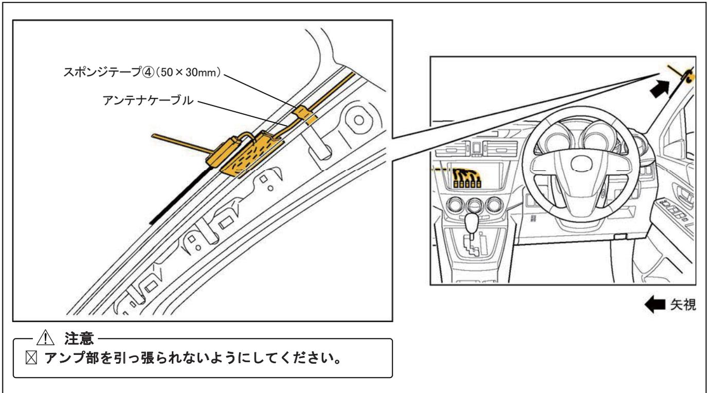
2. アンテナケーブルをスポンジテープ④ (50×30mm) で固定します (助手席側)。
