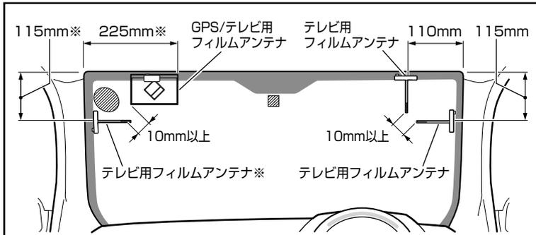
※助手席側のフィルムアンテナと定期点検ステッカー・検査標章部と干渉する場合は、以下の範囲内で貼付位置を調整してください。
