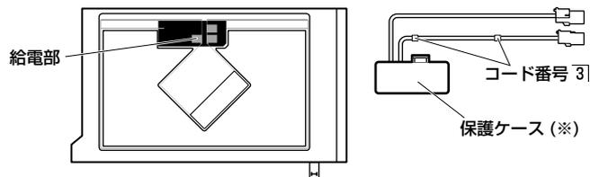
※ アンテナアンプは給電端子を保護するためケースに入っています。アンテナアンプの取り付け位置を確認する際や、実際にフィルムアンテナに取り付けを行う時以外はケースから取り出さず作業を行ってください。
