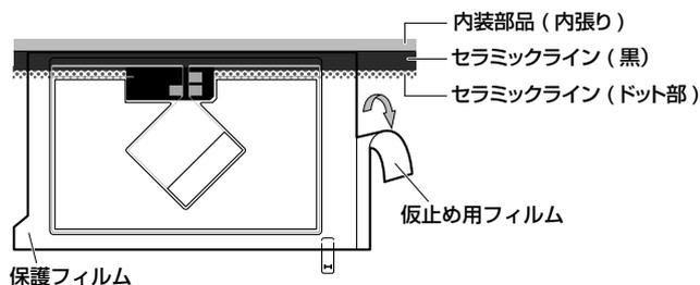
2) タグ[I]の透明フィルムをゆっくりはがして、フィルムアンテナをしっかりとガラスに密着させる。
