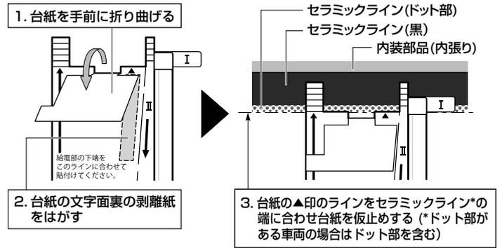
2) タグ[I]の透明フィルムを ゆっくりはがして、フィルムアンテナをしっかりとガラスに密着させる。
