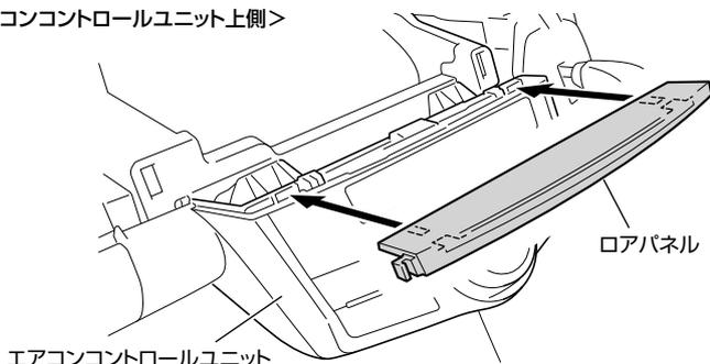
4. エアコンコントロールユニットにロアパネルを取り付けます。
