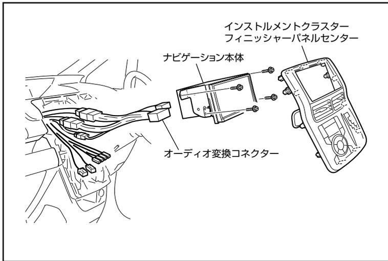
4. 接続図を参照して配線を接続します。
