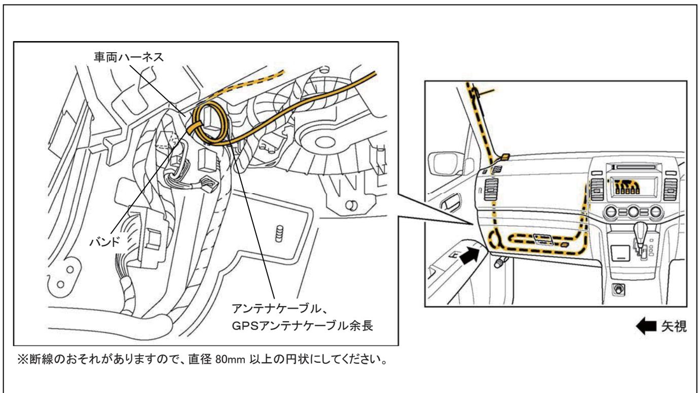
5. アンテナケーブルおよびGPSアンテナケーブルをバンドで車両ハーネスに固定します。
