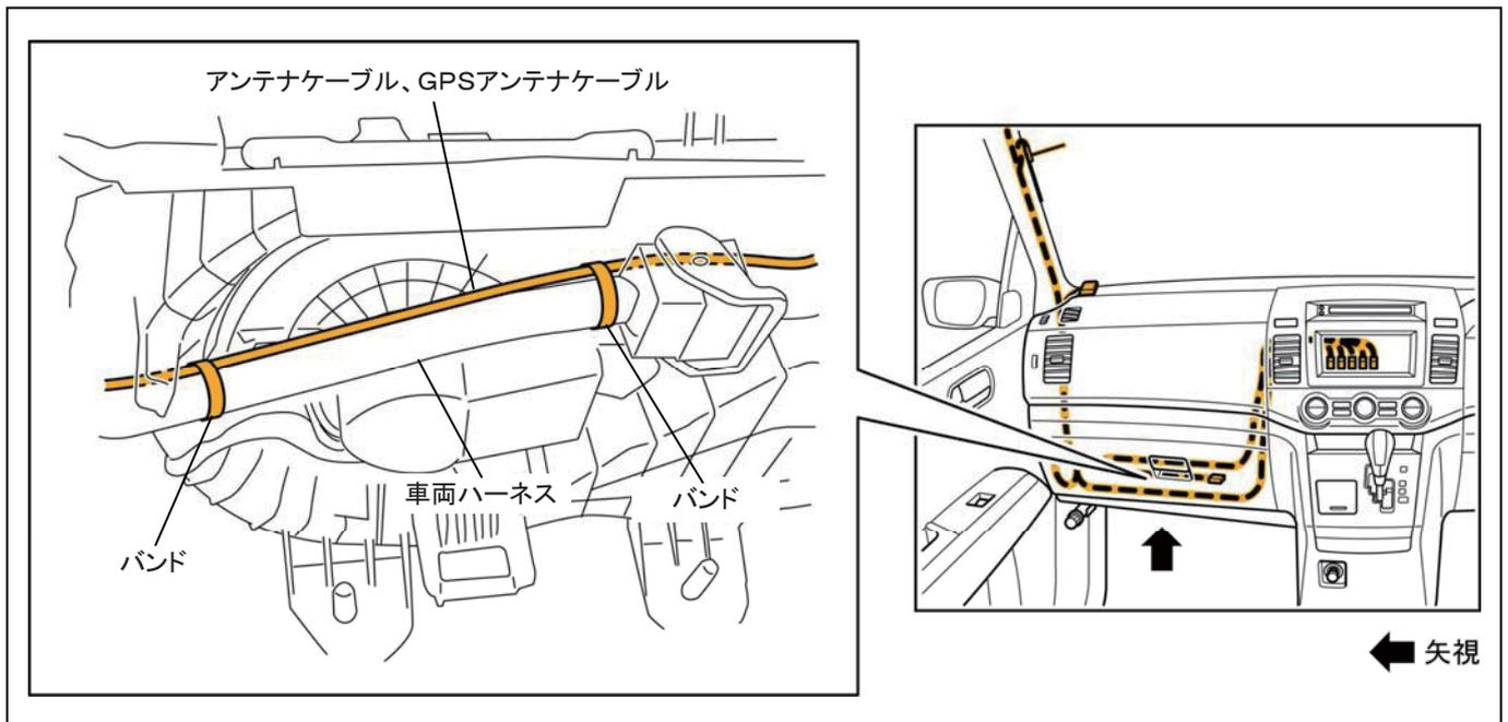
6. アンテナケーブルおよびGPSアンテナケーブルをバンドで車両ハーネスに固定します。
