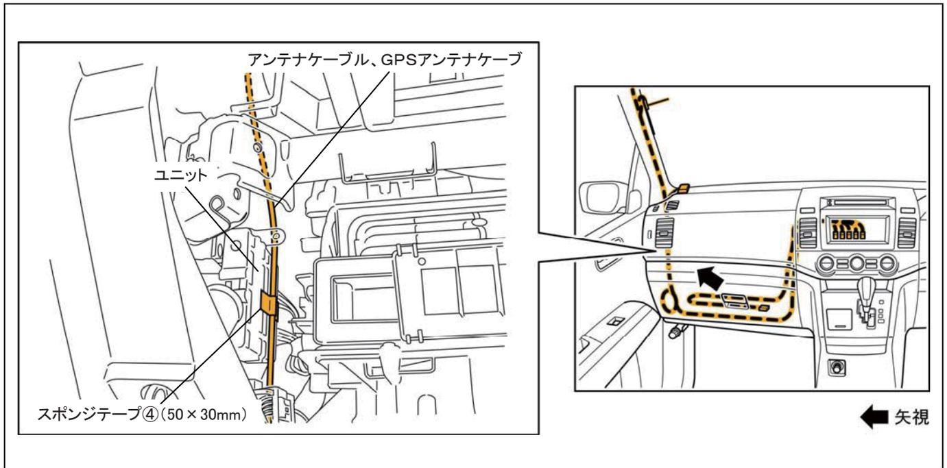
4. 図示の位置でアンテナケーブルおよびGPSアンテナケーブルの余長を束ね、バンドで車両ハーネスに固定します。
