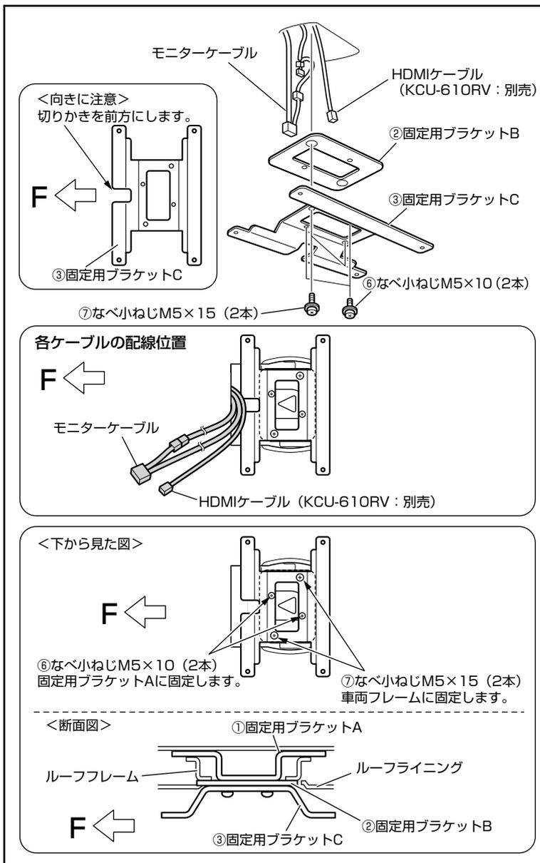
2. ②固定用ブラケットBと③固定用ブラケットCを、⑥なべ小ねじM5×10と⑦なべ小ねじM5×15で①固定用ブラケットAと車両フレームに固定します。
