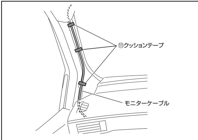
3. 助手席側Aピラーに各ケーブルを①クッションテープで固定し、Aピラー下のすき間へ配線します。
