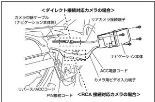
4. 電源ユニットのPIN接続コード、リバー/ACCコード、アースコードをオーディオスペースまで配線します。
