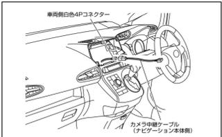
■カメラ中継ケーブル (バックビューカメラ側) の接続
