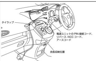
■電源ユニットの設置 (RCA接続対応カメラのみ)
