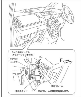
■電源ユニットの設置 (RCA接続対応カメラの場合)
