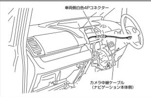
■カメラ中継ケーブル (バックビューカメラ側) の接続
