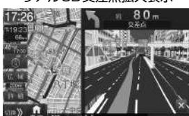
リアル3D交差点情報のある交差点が近づくと、よりリアルな拡大図が表示されます。
