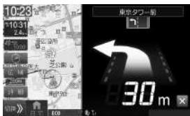
ルート案内中に案内ポイントが表示されている交差点が近づくと、矢印で進行方向を表示します。
