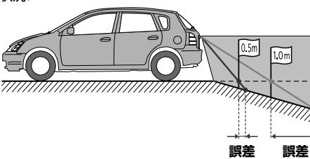
下り坂が後方にあるときには、実際の距離よりうしろに距離目安マークが表示されます。
