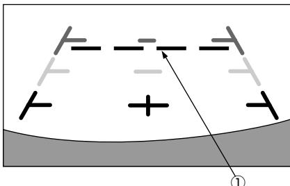
① バックドア(トランク)開閉目安マーク(水色)
