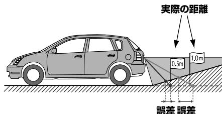
距離目安マークは平らな路面に対しての距離の目安を示しています。そのため上り坂が後方にあるときには、実際の距離より手前に距離目安マークが表示されます。例えば上り坂に障害物があった場合には、実際より遠くにあるように見えます。同様に目安線と実際の路面上の進路にも誤差が生じます。
