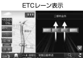
ETCレーン情報のある料金所が近づくと表示されます。ETC・ETC2.0車載器(別売)にETCカードが装着されている場合はETCレーンに矢印が表示されます。
