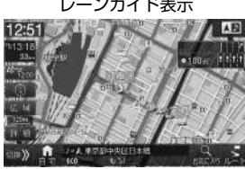
レーン情報のある分岐交差点が近づくと(約10km以内)、交差点までの距離と走行レーンが表示されます。
