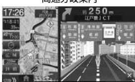
有料道路や高速道路を走行中に情報のある分岐点(JCT)が近づくと表示されます。レーンごとに方面が表示されます。
