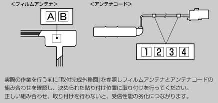
実際の作業を行う前に「取付完成概略図」を参照してフィルムアンテナとアンテナコードの組み合わせを確認し、決められた貼り付け位置に取り付けを行ってください。正しい組み合わせ、取り付けを行わないと、受信性能の劣化につながります。
