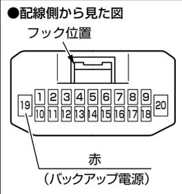
モニターケーブルのACCコードとバッテリーコードは、エレクトロタップなどで接続してください。
