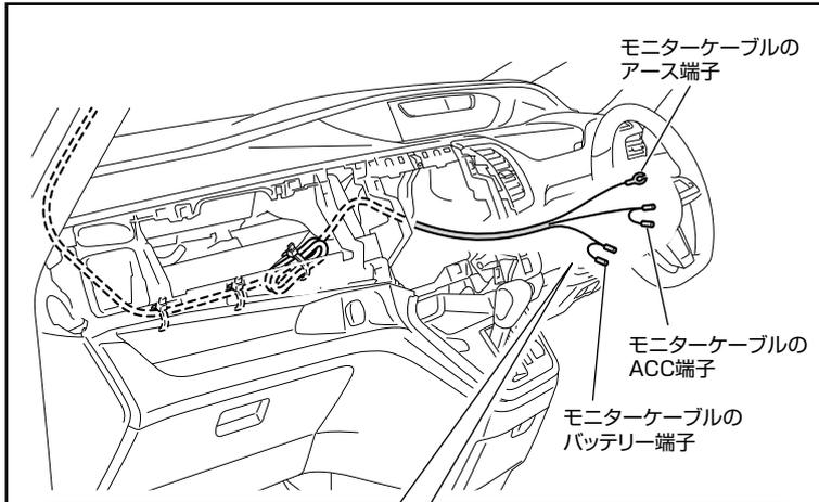
1. モニターケーブルのACC端子とバッテリー端子の先端をカットします。
