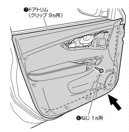
・ドア側に残ったクリップはクリップ外しで取り外し、 ドアトリムの所定位置に取り付けます。
