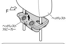
ヘッドレストシャフトの幅に合わせてヘッド レストシャフト取付部を調整してください。 ヘッドレストシャフト取付部 ¶
