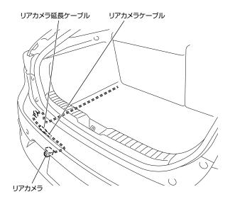
7. 取付概要図を参照して、リアカメラ延長ケーブルを取り付けます。
