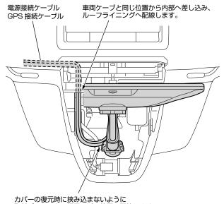
カバーの復元時に挟み込まないように 取付ブラケットの根元に近い位置に配策します。
