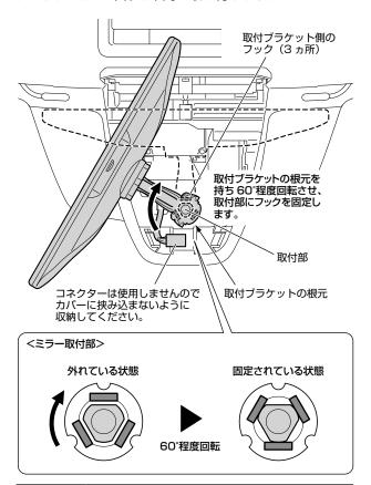
●取り付ける際は、取付ブラケットの根元 や車両側の取付部を破損させないように 注意してください。
